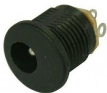
DC021-2.5 Gniazdo DC, męskie, kołek \varnothing 2.5 mm, otwór D\varnothing 5.8 mm, do montażu w płycie \varnothing 16.0 mm, 0.5A, 50V DC, RoHS
