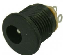
DC021-2.0 Gniazdo DC, męskie, kołek \varnothing 2.0 mm, otwór D\varnothing 5.8 mm, do montażu w płycie \varnothing 16.0 mm, 0.5A, 50V DC, RoHS
